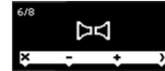
Im Betrieb schaltet das Radio automatisch zwischen Stereo- und Monobetrieb um. Bei wechselnden Empfangsverhältnissen kann es sinnvoll sein, dauerhaft den Monobetrieb zu wählen.
