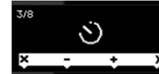
Mit dem Sleptimer (Einschlaf-Funktion) wird das Radio nach der gewählten Zeitdauer automatisch ausgeschaltet. Der Countdown wird in der Statuszeile angezeigt.
