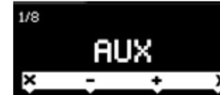
Bei aktiviertem AUX-Eingang wird der Radioempfang beendet und die Wiedergabe erfolgt von der externen Quelle. Wird der Eingang deaktiviert, erfolgt erneut der Radiobetrieb.
